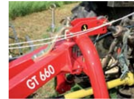
3-Punkt-Schwenkbock verfügbar für die Modelle GT 440/500/540 und 660 zwecks besserer Manövrierbarkeit.
