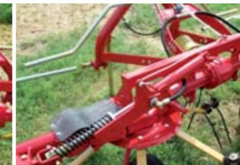
Mittels eines Hydraulik-Nachrüstsets kann das Modell GT400 mit manueller Klappung in wenigen Minuten auf eine hydraulische Aushebung umgerüstet werden.
