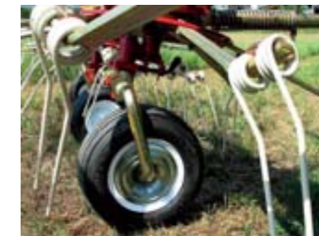
Erstklassige 9,5 mm starke Qualitätszinken aus eigener Tonuttifertigung garantieren lange Standzeiten.
