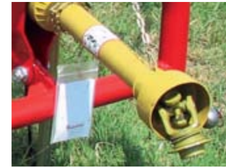
Kategorie S4 Zapfwelle mit Schnellkuppler.
