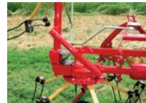
Mittels eines Hydraulik-Nachrüstsets kann das Modell GT400 mit manueller Klappung in wenigen Minuten auf eine hydraulische Aushebung umgerüstet werden.
