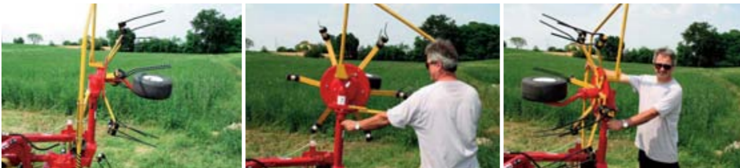
Außenkreisel um 180° drehbar zum Reduzieren des Raumbedarfs beim Transport - verfügbar für die Modelle GT 380/440/500/540, 3-Punkt Versionen.
