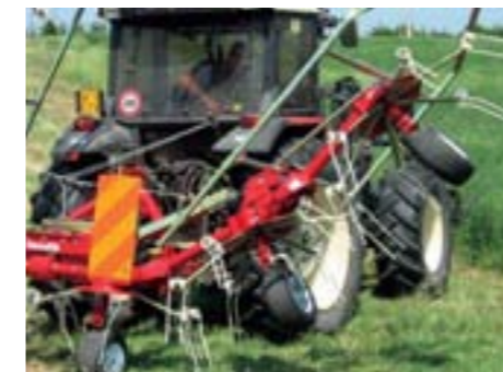
Hydraulische Synchronaushebung in die Transportposition, verfügbar für alle Modelle von GT 380 bis 660.
