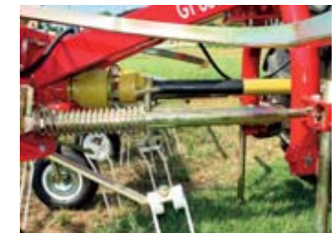
Optional erhältlicher Seitenstabilisator zum sicheren Ausheben am Hang für Maschinen mit Dreipunkt Schwenkbock. Das Modell GT660 ist serienmäßig mit dem Seitenstabilisator ausgestattet.
