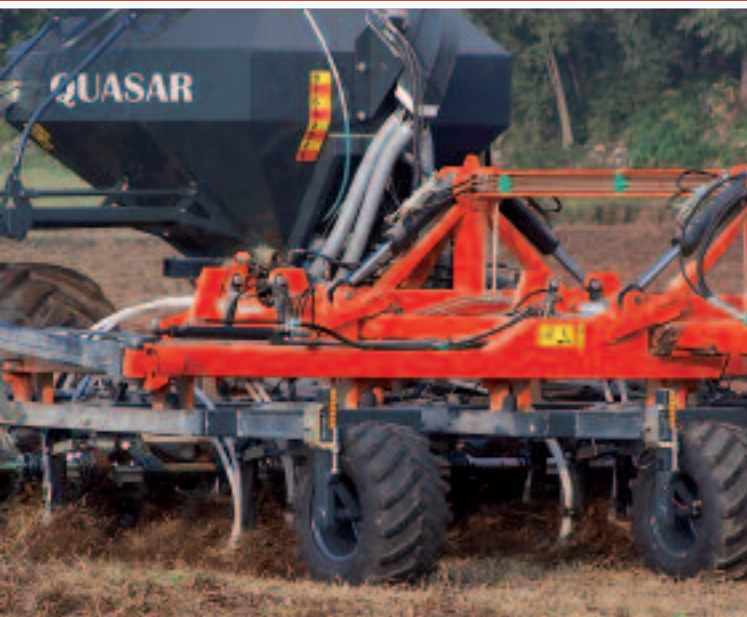
Detailaufnahme der Schare und des Rahmens
