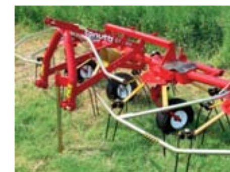
Attacco al terzo punto fisso nei modelli GT 250-310-380-440 per una maggiore stabilità del girello durante le fasi di lavoro in collina/montagna.
