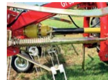
Freno meccanico disponibile su richiesta per i modelli con 3 Punto snodato - di serie per i modelli GTH 660 e GTH 780.
