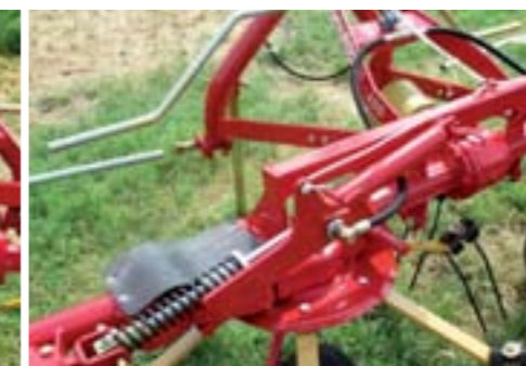
Disponibile un kit per trasformare i girelli dalla versione meccanica in quella idraulica - modello GT 400.
