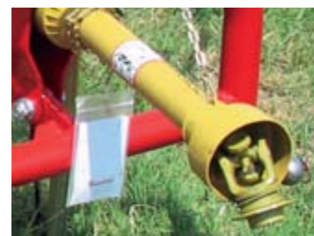
Albero cardanico dotato di sgancio a collare.
