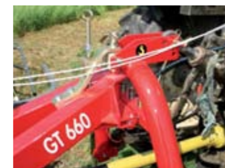
Attacco al terzo punto snodato disponibile nei modelli GTH 440-500-540-660-780 - per una migliore manovrabilità.
