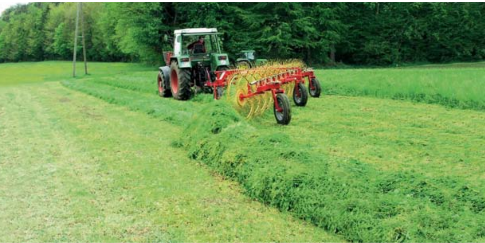
RANGHINATORE TRAINATO IN LINEA mod. T 4GW con 4 ruote gommate
