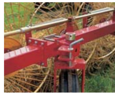
Dispositivo con piastra di regolazione per il bloccaggio della ruota direzionale in fase di lavoro.
