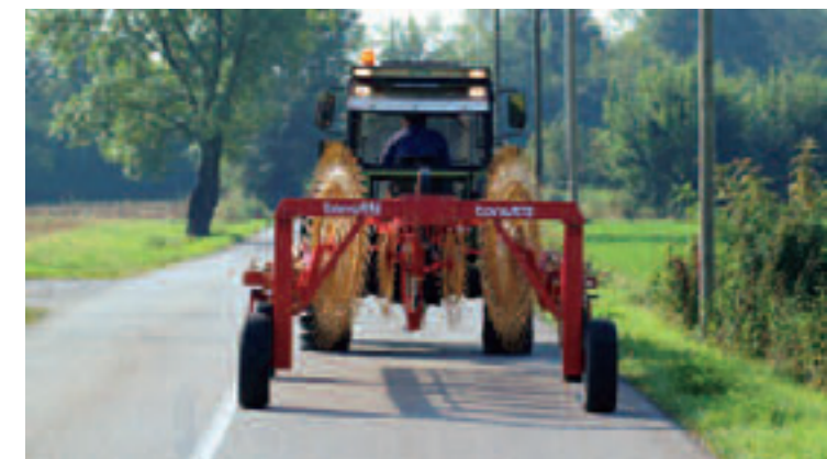
Легкая и быстрая транспортировка по дороге. Транспортная ширина – 2,50 м (8'4").
