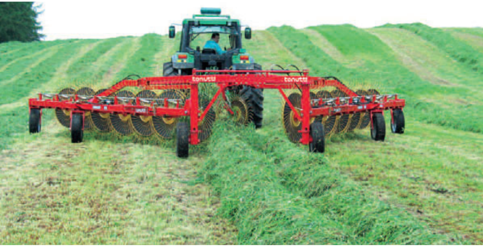
DOMINATOR V 14 - ширина захвата 8,50 м (28'4") - сбор в валки травы
