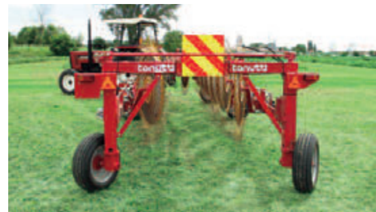
Новый автоматический механизм позволяет граблям идеально следовать по траектории трактора, увеличивая маневренность.
