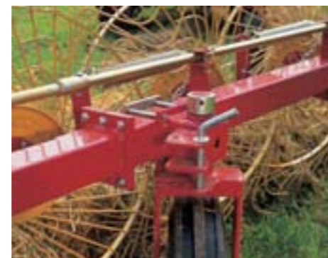
Dispositivo con placa de ajuste para el bloqueo de la rueda direccional durante el trabajo.
