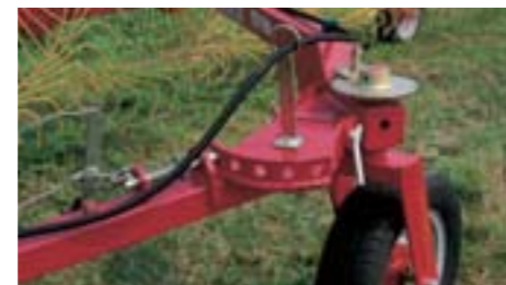
Timón con sector ajustable para los distintos anchos de trabajo.
